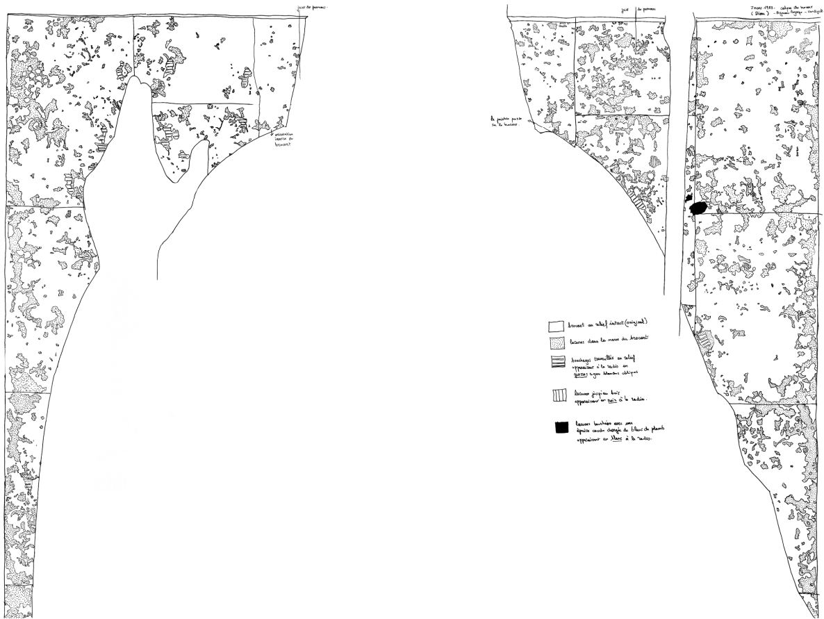
Fig.13. Schadepatroon op basis van XR (KIK M. Serck-Dewaide)
