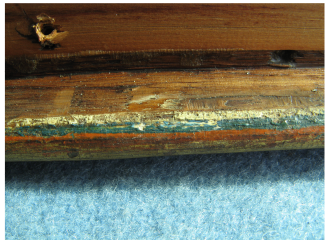
Bovenzijde sponning: Witte grondering, blauwe verflaag, rood-oranje onderlaag van de mixtion onder de vergulding van de lijst
