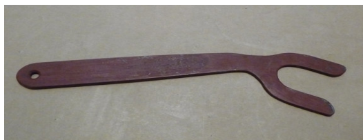
Sleutel nodig om het veringmechanisme te deblokkeren
